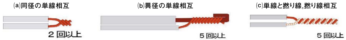
図6-3 芯線の捻り合せ（直接接続）
